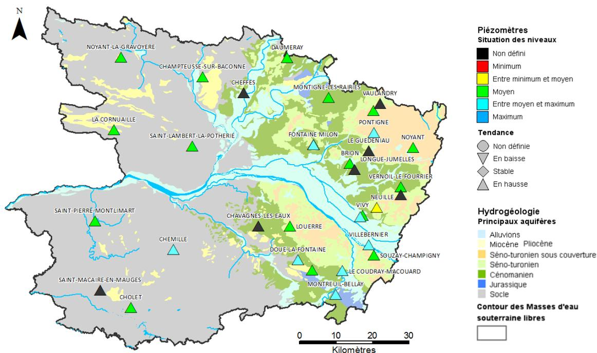
En janvier et février, sous l'effet des précipitations abondantes, la hausse des niveaux piézométriques s'est poursuivie et accélérée pour l'ensemble des nappes observées. Dans le cas des nappes les moins réactives (nappe du Cénomaniens à Brion, nappe du Miocène à Doué-la-Fontaine, nappes de socle à Noyant-la-Gravoyère et Saint Pierre Montlimart), la recharge s'est amorcée au tout début du mois de janvier.
